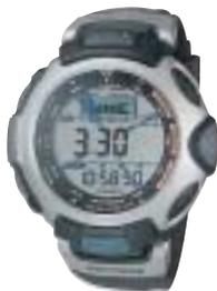
SOIなどの省電力技術を駆使して、従来は困難だった方位や高度などのセンサー計測をソーラー駆動で実現した高性能アウトドアウォッチです。
