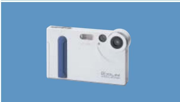
当社はカードサイズの液晶デジタルカメラ「EXILIM」を6月に発売。厚さわずか11.3mmの世界最薄ボディに本格的な性能を搭載しました。起動後1秒で撮影可能、シャッターボタンを押してから画像が記録されるまで約0.01秒。次の画像が撮影可能になるまで約0.6秒。このクイックレスポンスによりシャッターチャンスを逃しません。また大型セルCCDの採用で鮮明な画質を実現しました。薄型化と高性能の両立には、インバートテッサー方式のレンズ構成に新開発CCDを組み合わせたHCLi(Hyper CCD-Lens integration)、処理チップをシリコンチップレベルでモジュール化したMCM(Multi Chip Module)、
