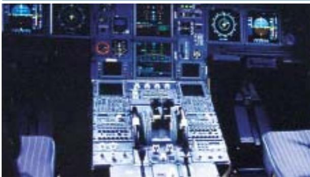
高度、速度、位置情報、管制塔からの指示など、多彩な情報が表示される航空機の操縦席。当社はこのたび、欧州エアバス社のA340型機の操縦席に搭載する表示パネルの供給を開始しました。航空機での厳しい使用条件に耐える高い耐久性と信頼性、昼間から夜間まであらゆる光線下で鮮明な画像が表示でき、かつ操縦士席・副操縦士席のどちらからでも全く同じ情報を見ることができる優れた視認性を実現した当社の液晶技術が高く評価されたものです。供給を開始したのは8.8インチ高精細TFT液晶パネルで、1機あたり6枚使用されており、今年度中に約1,000枚、2005年度には3,000枚を供給していく予定です。
