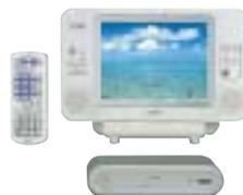
デジタル無線伝送システムの採用により、モニターとチューナーを分離。バスルームやキッチンなど、屋内のどこでもモニターを持ち歩いて、鮮明な映像を楽しむ防水液晶テレビです。
