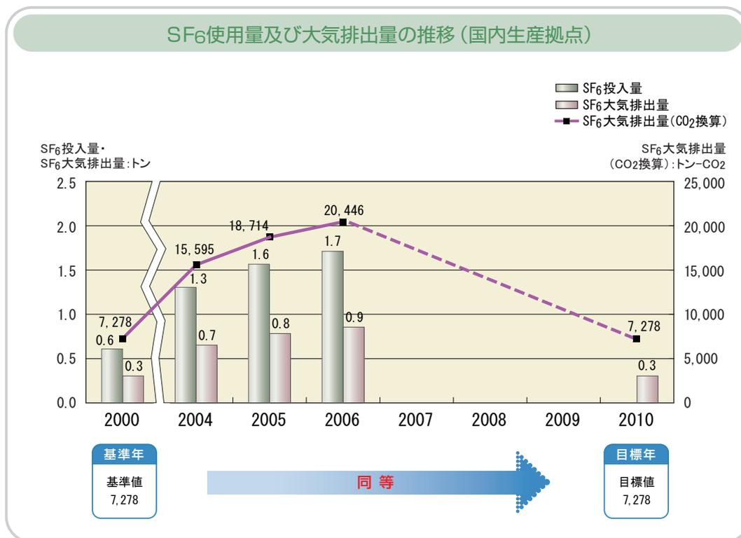
SF<sub>6</sub>の使用量は生産量の増大で2006年度は2005年度に比べて0.1トン増加していますが、2010年の削減目標達成のため、代替プロセスの開発や除害設備の導入等を推進中です。
