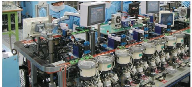
この「自動組み立てライン」はレイアウト自由度の高い完全分離型ユニットベースを採用し、複数機種の混流生産可能なラインを実現。またリニアモーターによる独自開発の5軸ロボットはマルチヘッドを搭載し、多種部品への対応や、組み立ての高速化などを実現しています。特に時計・分針・秒針の直径3mm程度の歯車には針位置補正用の約300マイクロメートルの穴を設けてあり、画像センサーを搭載した組み立て装置がこの歯車の表裏判定、穴位置検出による位置合わせを行います。高精度な組み込み技術の確立によって、高信頼性と高機能性をもつタフムーブメントの安定供給に貢献しています。
