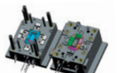
金型 緻密なプラスチック成形を実現する高精度金型
