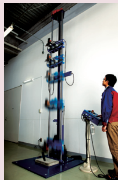
独自の350cm自動引き上げ式カスタム落下試験機
