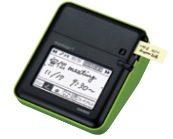
memopri (メモプリ) MEP-T10 手書きメモを付箋タイプのテープに印刷できる小型プリンター
