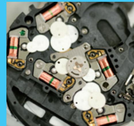
フルメタル電波ソーラー時計「OCEANUS」を駆動する「タフムーブメント」。ムーブメント自体が耐衝撃性を備え、標準電波で時刻を修正し、使ううちに生じるわずかな針ずれをも自ら補正する仕組みを備えています。
